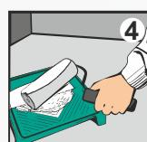
Нанесите краску на поверхность кистью, валиком или распылением в два слоя с промежуточной сушкой не менее 2 часов. Через 24 часа после нанесения последнего слоя возможна эксплуатация покрытия в щадящем режиме, через 14 дней покрытие приобретает окончательную прочность.
